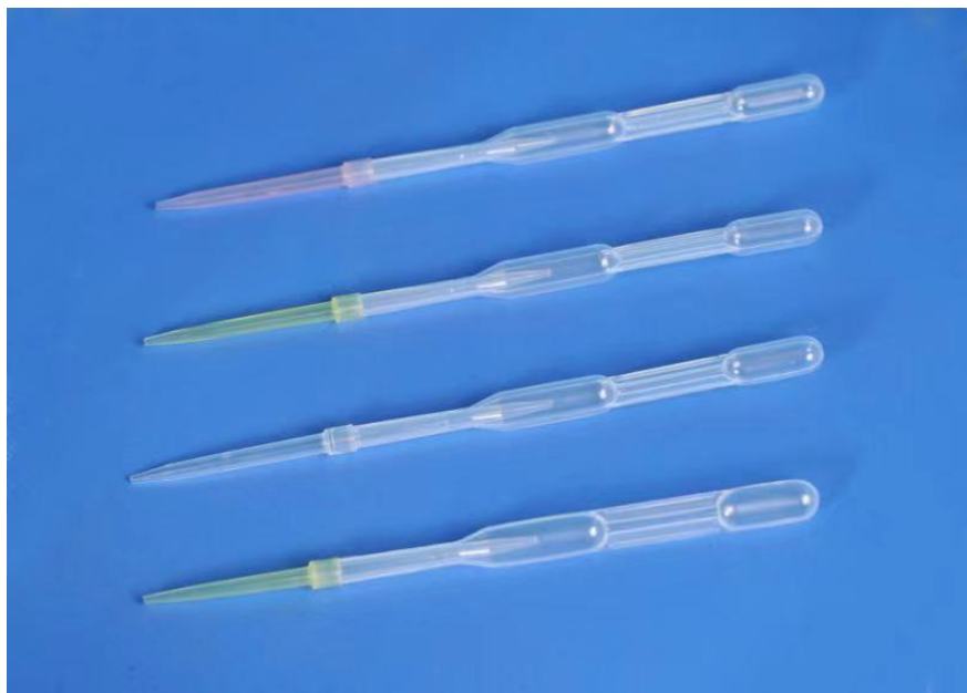
精确定量吸管 精度达到正负1%
